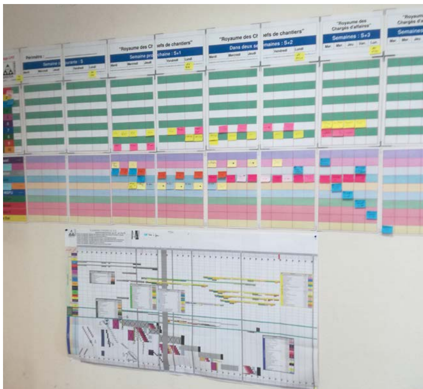
▲ Planning collaboratif de l'opération à trois semaines (en haut) et planning d'opération (en bas)
